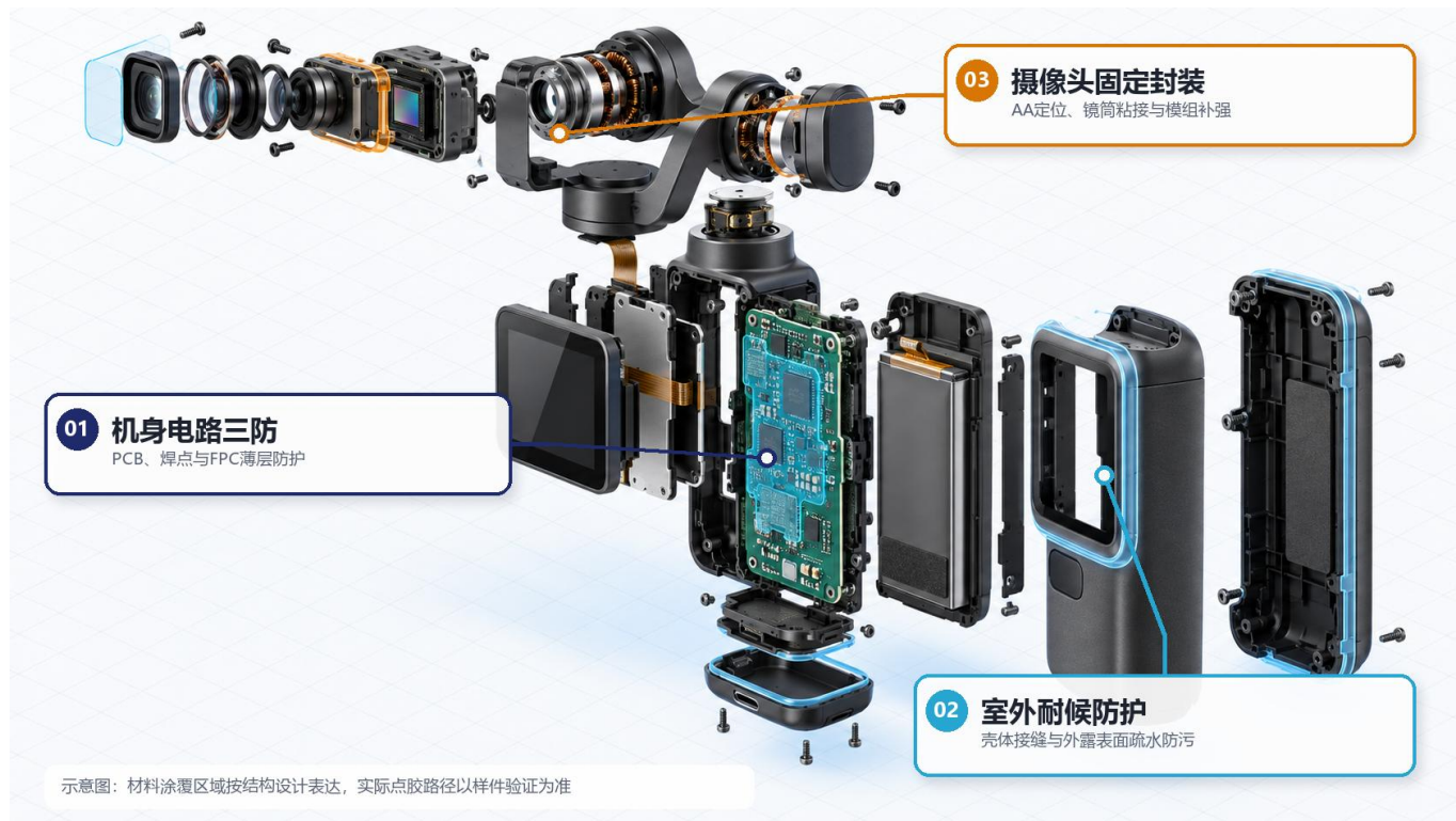
图 2 口袋云台摄像头拆解与材料应用部位
